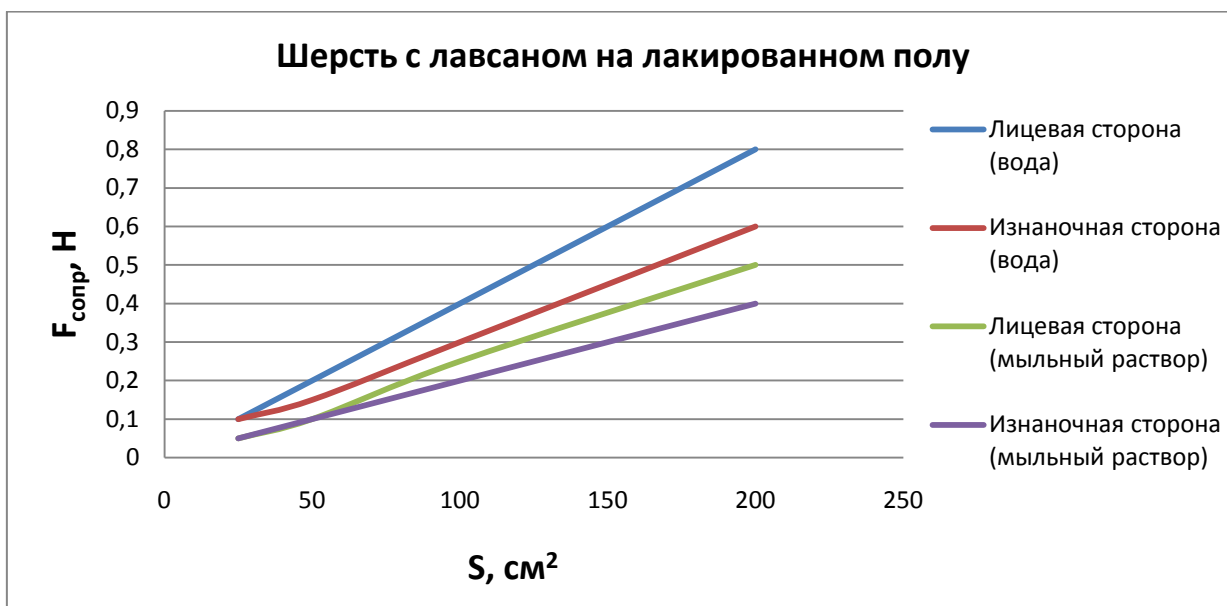
График 10.1. Зависимость силы сопротивления от площади соприкосновения шерсти с лавсаном с лакированным полом
