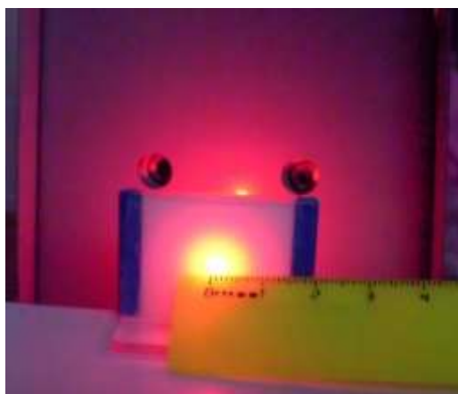
Рис. 7. Определение диаметра лазерного луча после прохождения через слой молока (He-Ne лазер)
