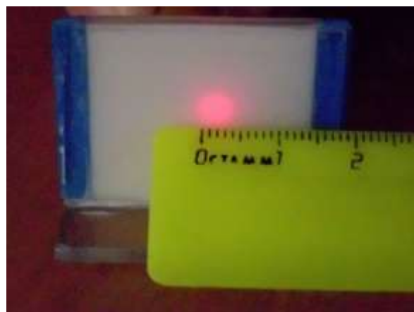
Рис. 8. Определение диаметра лазерного луча после прохождения через слой молока (полупроводниковый лазер)
