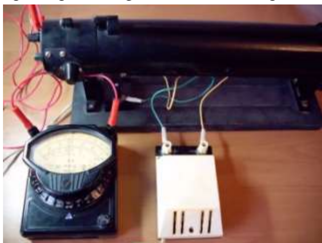
Рис. 6. Установка для определения жирности молока фотометрическим методом
